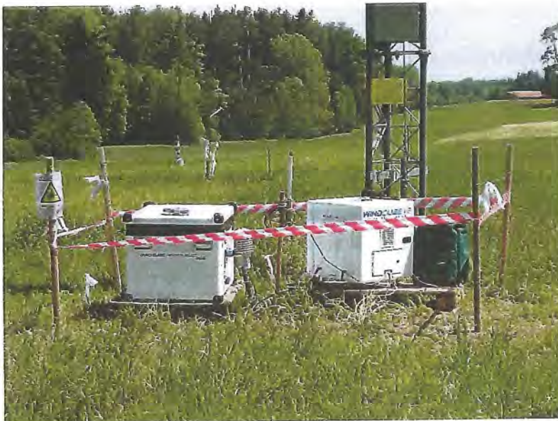
Abb. 7: LiDAR-Gerät beim Mastfuss am Standort Thundorf (Waldhof).
