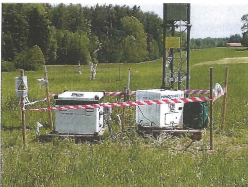
Abb. 7: LiDAR-Gerät beim Mastfuss am Standort Thundorf (Waldhof).
